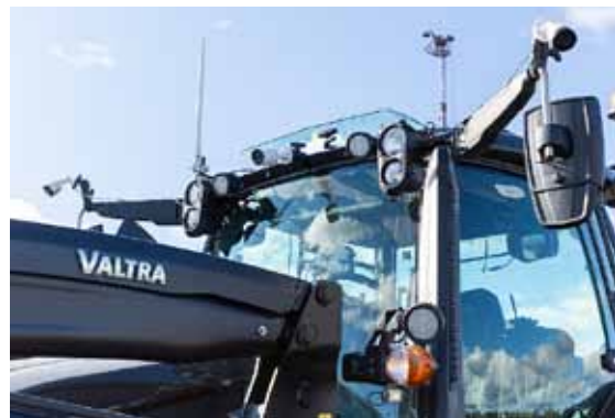
Zamontowane na zewnątrz kamery pokazują sterującemu, co dzieje się wokół ciągnika.
