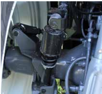
Kabina z tyłu osadzona jest na dwóch amortyzatorach o regulowanym ręcznie stopniu twardości, a z przodu na silentblokach.
