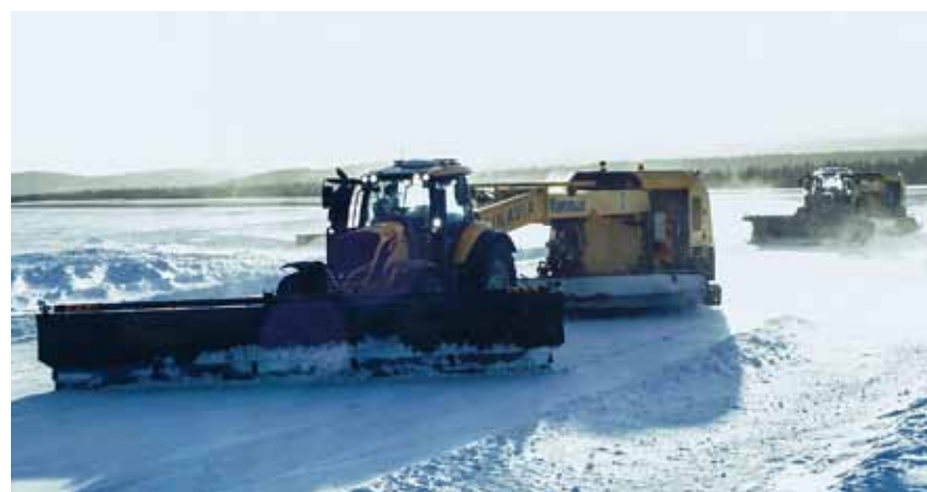
Ciągnikiem steruje się z wnętrza samochodu, ale możliwe jest też sterowanie z wnętrza innego ciągnika, lub też w ograniczonym stopniu przy użyciu przenośnego kontrolera.
