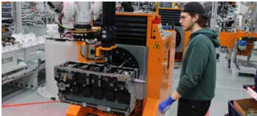
Mechanik Julius Salmela instaluje wał korbowy za pomocą robota przemysłowego.
