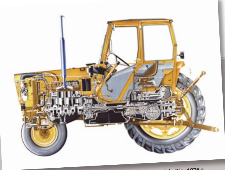
Część ręcznego rysunku Valmet 702 autorstwa Antamo Vaajakallio, 1976 r.
