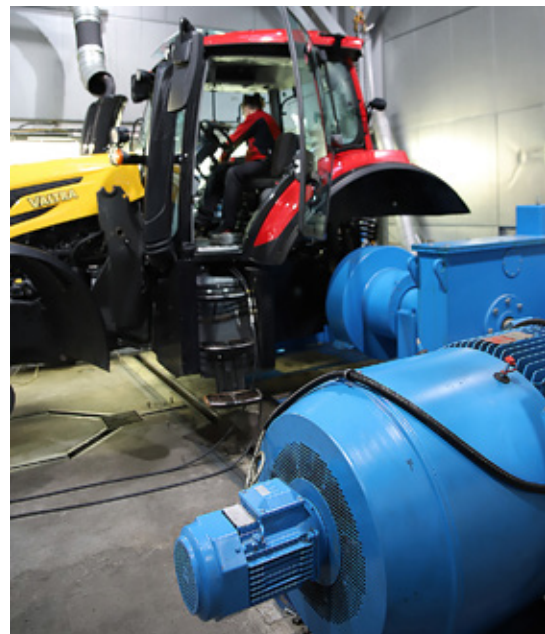
Jan-Erik Karjula prowadzi traktor na podłożu testowym. Wyniki będą wykorzystane do dalszego rozwoju zarówno traktora, jak i symulatora.
